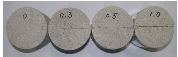
그림 3. 모르타르 시험체의 균열발생 유도
